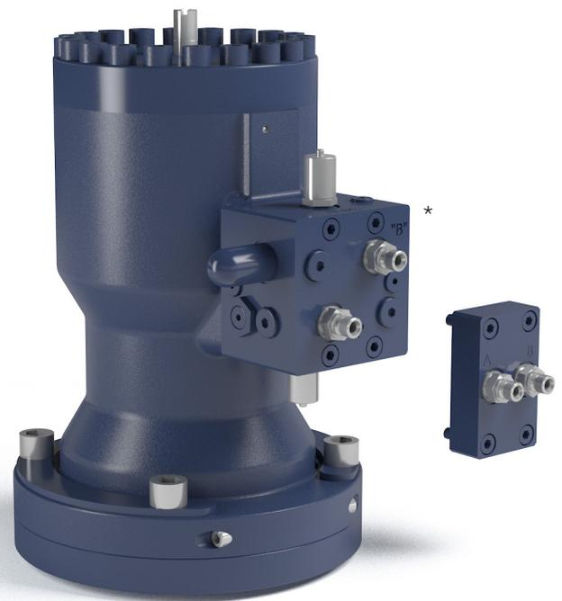
\* Im Falle einer Beschädigung des Hydrauliksystems stellt der Steuerblock sicher, dass der hydraulische Druck im Antrieb erhalten bleibt und die Ventile in ihrer Position bleiben. Zusätzlich kann der Druck durch den Steuerblock in jedem Antrieb individuell gesteuert werden.
