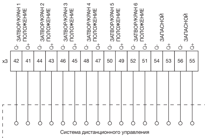
Рис. 29. Подключение для аналоговых сигналов дистанционного управления
