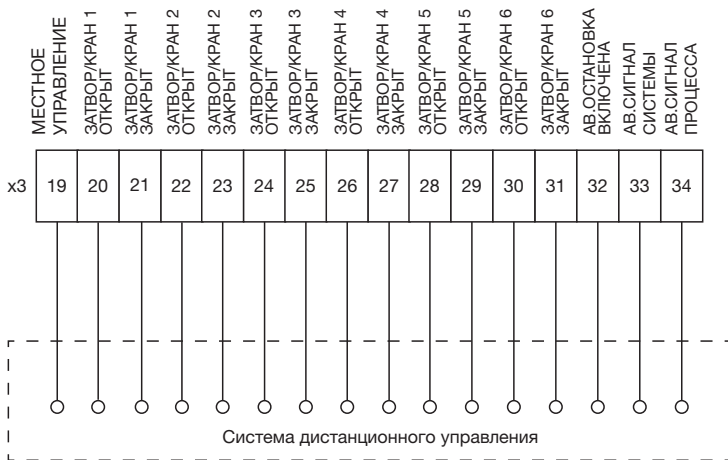
Рис. 28. Подключение выходных клемм дистанционного управления
