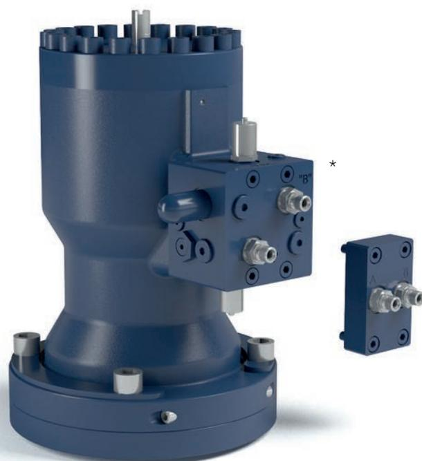
\*Le bloc de commande hydraulique assure le confinement de la pression hydraulique à l'intérieur de l'actionneur en cas de dommage aux conduites hydrauliques. Il peut être utilisé pour ajuster l'entrée de pression hydraulique des différents actionneurs.
