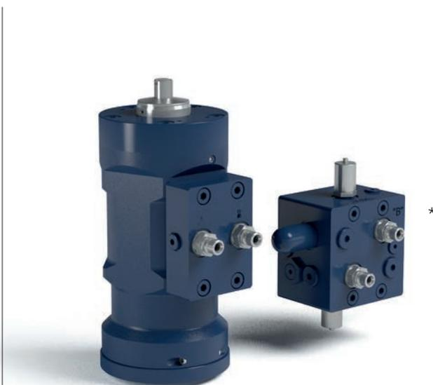
\*Le bloc de commande hydraulique assure le confinement de la pression hydraulique à l'intérieur de l'actionneur en cas de dommage aux conduites hydrauliques. Il peut être utilisé pour ajuster l'entrée de pression hydraulique des différents actionneurs.
